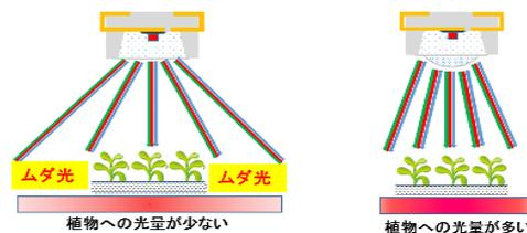
\* 格子状に配置したLEDにレンズを取付け、各LEDの光出射角を最適配置する。
